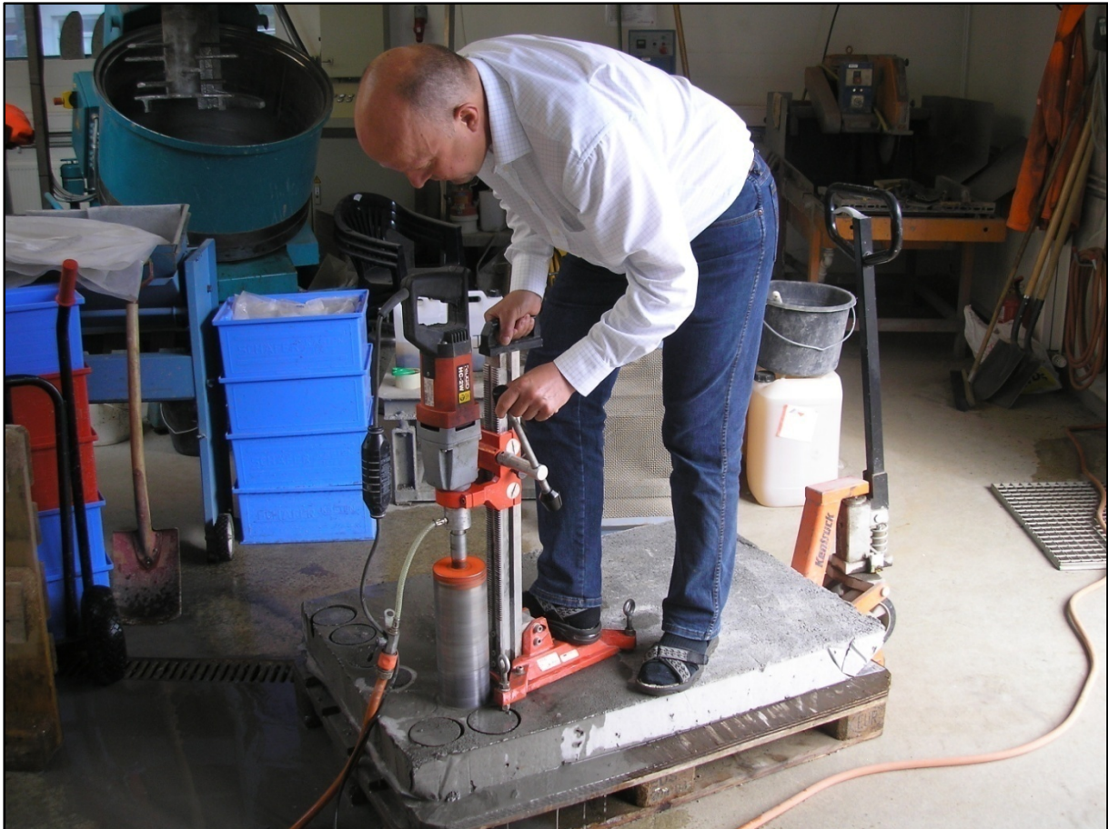
Mynd 3. Steypa sem var útbúin og notuð við prófanir á mismunandi þéttiefni.
